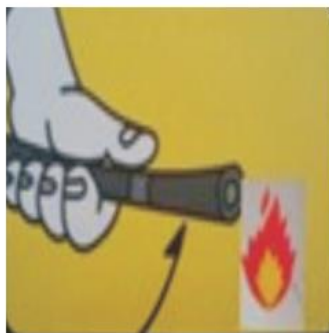
握住皮管，将喷嘴对准火苗根部
